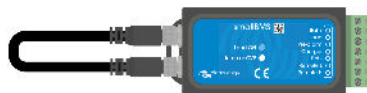
Testez un Small BMS en branchant une seule rallonge BMS aux deux connexions du câble BMS
