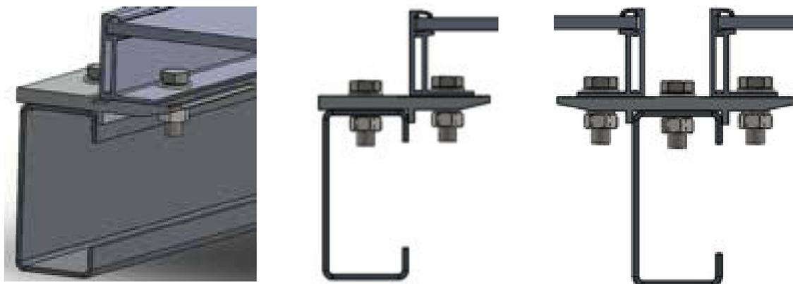
Figure 7 Méthode d'Installation
