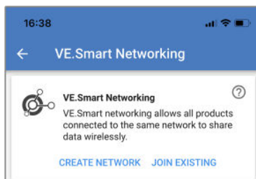
Création d'un réseau VE.Smart à l'aide de l'application VictronConnect.
