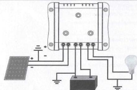
Remarque : A l'intérieur du contrôleur, les anodes sont connectés ensemble, ainsi si vous souhaitez connecter le système à la terre, il faut le faire au travers de l'anode (+)
