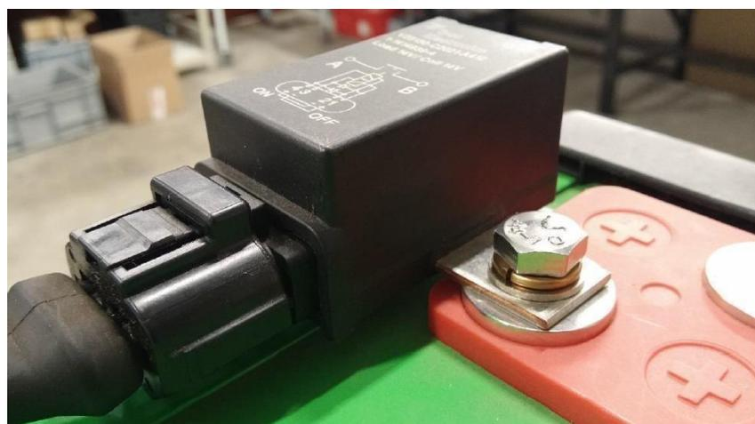
Respecter l'ordre d'empilement des rondelles sur la plage de raccordement (voir photo ci-dessous). Pour chaque raccordement, vous devez mettre sur la vis inox (2), la rondelle freins (3) puis la rondelle Inox (4) pour le passage du courant. Appliquer un couple de serrage de 13N.m. Le relais de protection Super B est limité à 250A en continu. Pour toute installation d'un convertisseur supérieur à 3000W, veuillez contacter Super B pour commander un relais de plus grande intensité.
