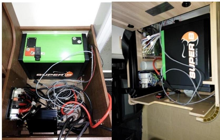
Installer le relais de protection sur la borne rouge (+) puis connecter le câble fournit avec le relais de protection sur ce dernier.
